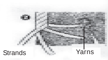
ఫ్రౌడ్ లెయిడ్ రోప్ ( Shroud laid rope )
